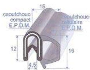
Réf. 6964 695 EPDM bi-duréte noir + armature métal. A = 1 à 2,5 mm rouleau de 50 m
