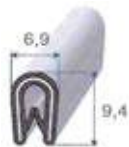
Réf. 1806 000 PVC noir + armature plastique A = 0,8 à 2 mm rouleau de 50 m coloris gris sur demande
