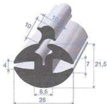
Réf. 6946 788 EPDM noir - 65 shore A \pm 5 rouleau de 25 m extrusion avec clé
