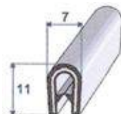
Réf. 6953 719 PVC noir + armature métal. A = 1,5 à 2,2 mm rouleau de 50 m
