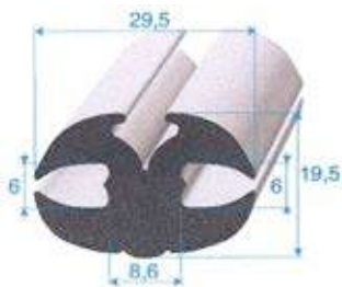
Réf. 1902 000 EPDM noir - 70 shore A \pm 5 rouleau de 25 m clé adaptable : 1903 000
