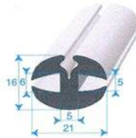
Réf. 1887 000 EPDM noir - 70 shore A \pm 5 rouleau de 50 m clé adaptable : 7260 270
