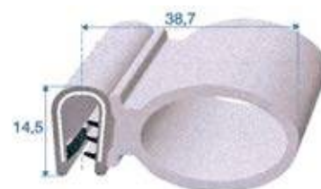
Réf. 1890 000 PVC+EPDM cellulaire noir + armature métal. A = 2 à 3 mm rouleau de 25 m
