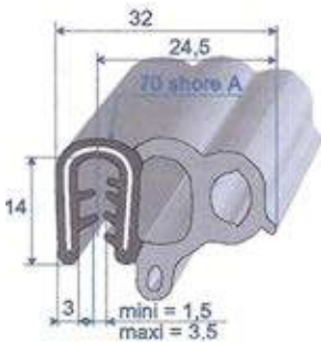
Réf. 6979 600 EPDM bi-durété noir + armature métal. A = 1,5 à 3,5 mm rouleau de 50 m
