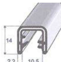
Réf. 6894 538 EPDM noir 70 shore A ± 5 + armature métal A = 7 à 8 mm rouleau de 50 m
