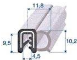
Réf. 1811 000 PVC+EPDM cellulaire noir + armature métal. A = 1 à 3 mm rouleau de 50 m
