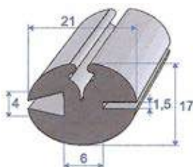
Réf. 6944 596 EPDM noir - 70 shore A ± 5 rouleau de 20 m clé adaptable : 7260 270
