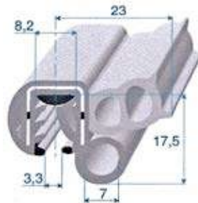
Réf. 1810 000 PVC+EPDM cellulaire noir + armature métal. A = 2,5 à 5,5 mm rouleau de 25 m
