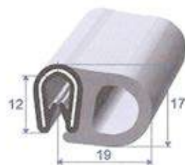
Réf. 6969 676 PVC + EPDM cellulaire noir + armature métal. A = 1,5 à 3 mm rouleau de 50 m
