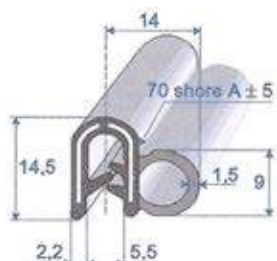
Réf. 6930 394 EPDM bi-duréte noir + armature métal. A = 1 à 3 mm rouleau de 25 m
