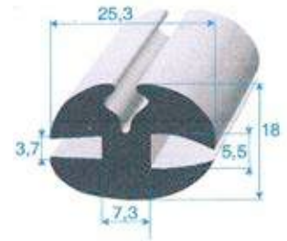
Réf. 1906 000 EPDM noir - 70 shore A \pm 5 rouleau de 50 m clé adaptable : 7260 270
