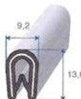
Réf. 1672 000 PVC noir + armature plastique A = 1,5 à 3 mm rouleau de 50 m autres coloris sur demande
