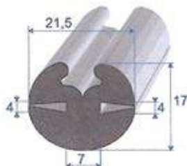
Réf. 7239 370 EPDM noir - 70 shore A ± 5 rouleau de 30 m clé adaptable : 7260 270
